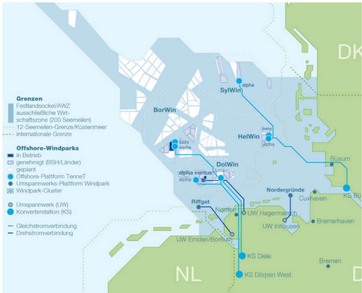
Abbildung 1: Geplante und bestehende Netzanbindungstrassen und Stationen von OWPs in der Nordsee. Der Abstand der Kabel beträgt Offshore 100m untereinander, die Verlegetiefe im Verkehrstrennungsgebiet beträgt 5m.
