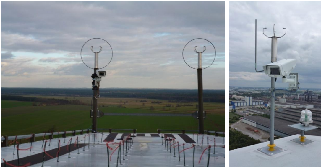
Abbildung 78: Versuchsaufbau des strömungsvisualisierenden Versuchs (links Vestas; rechts REpower).
