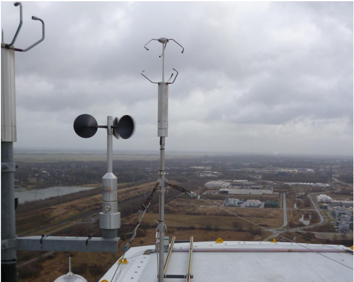
Abbildung 4: Thies Ultrasonic Anemometer 3D und Thies First Class Advanced Schalensternanemometer auf dem Gondeldach der Forschungs-WEA.
