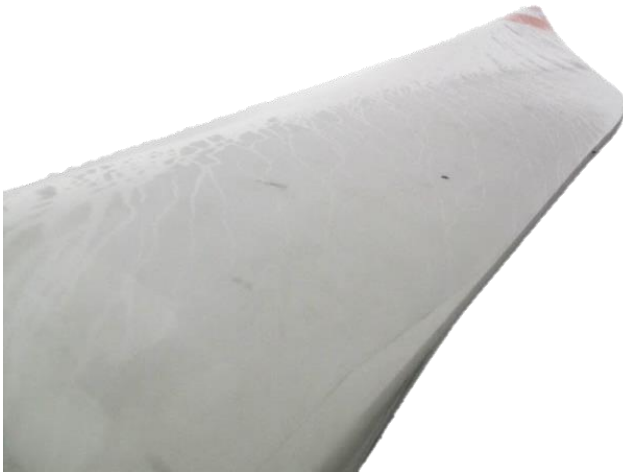
Abbildung 82 Regentropfen auf der Sogseite eines Vestas-Rotorblattes.
