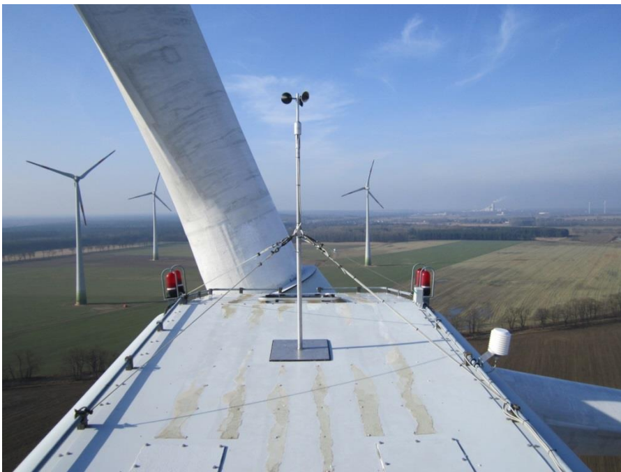
Abbildung 15: Installierte Messsystem auf dem Gondeldach einer der Testanlagen im Testwindpark
