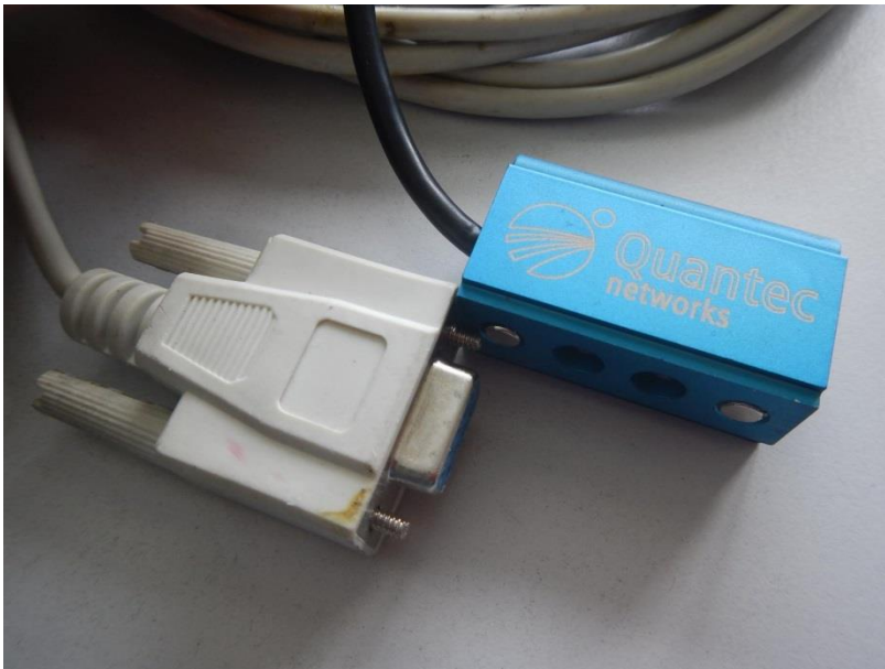
Abbildung 17: Optische Schnittstelle VCP-UART zur Kommunikation mit den Testanlagen
