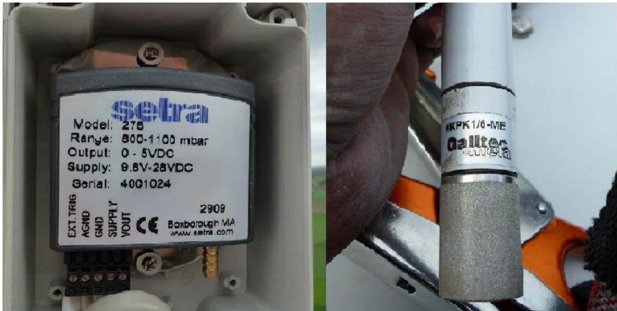
Abbildung 5: Auf der Forschungs-WEA in Bremen installierte Druck-, Temperatur- und Feuchtesensoren.
