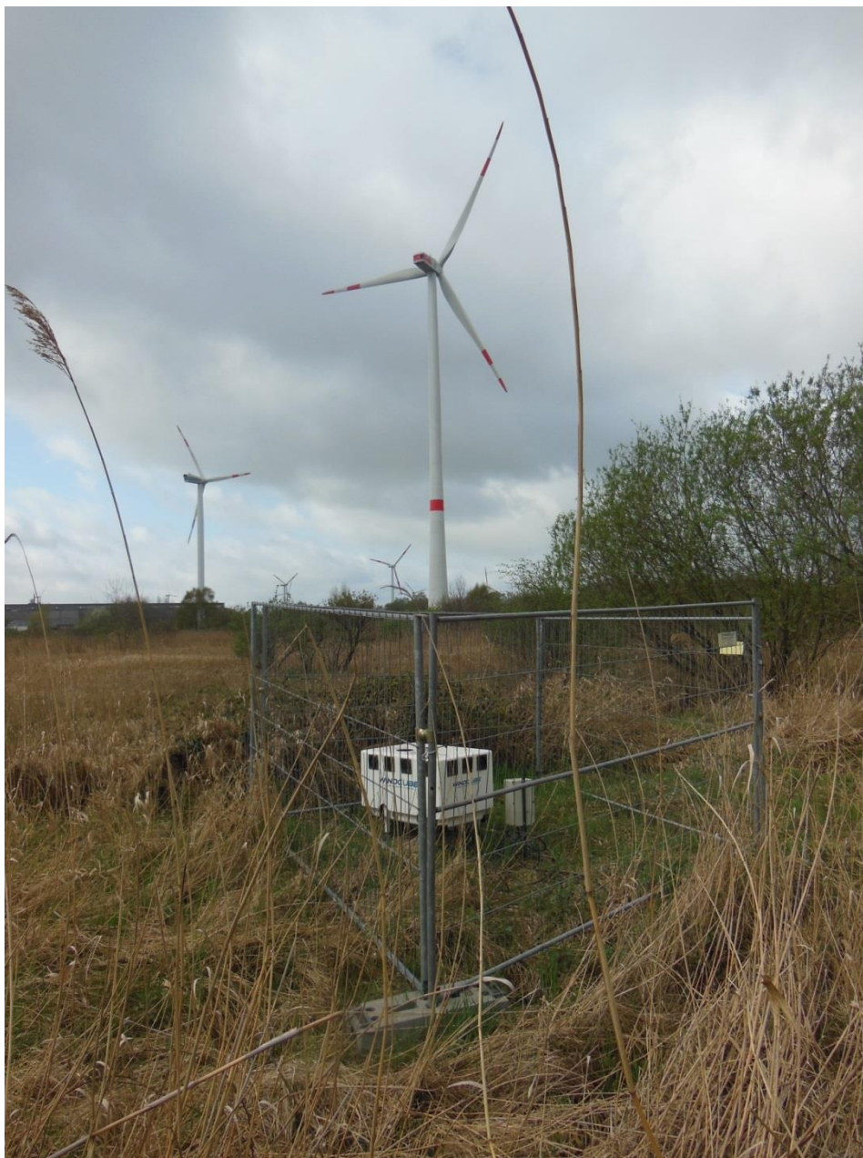
Abbildung 39: LIDAR vor WEA R300109 Bremen Stahlwerke
